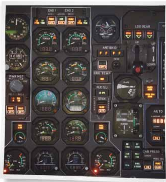
Seltener verdrücken: Eine neue Anordnung der Instrumente führte zu einer Verringerung der Fehler.
